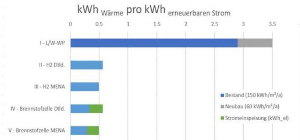
Abb. 28 Vergleich der Wirkungsgrade von strombasierten Wärmeerzeugern
