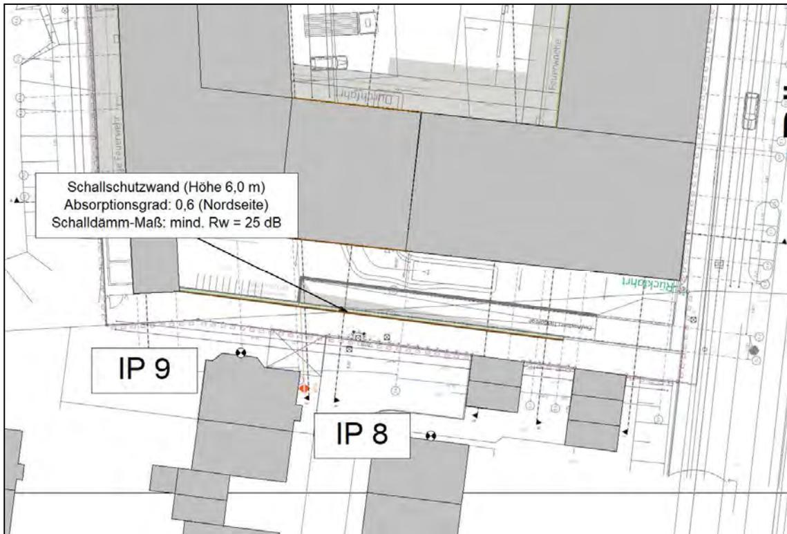
**Abb. 3.2** Detaildarstellung der Schallschutzwand im südlichen Grundstücksbereich
